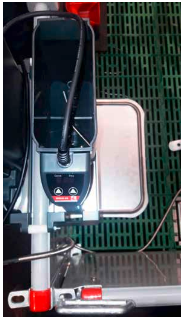
Bild 106: Dezentrale auf die Buchtentrennwand (für die Versorgung von zwei Buchten) aufgeschraubte Beifütterungstechnik
