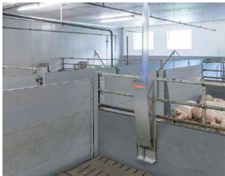
Bild 102: Pelletautomat (rechts) mit automatischer Befüllung und automatische Förderung (links)
