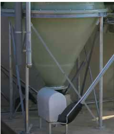
Bild 102: Pelletautomat (rechts) mit automatischer Befüllung und automatische Förderung (links)
