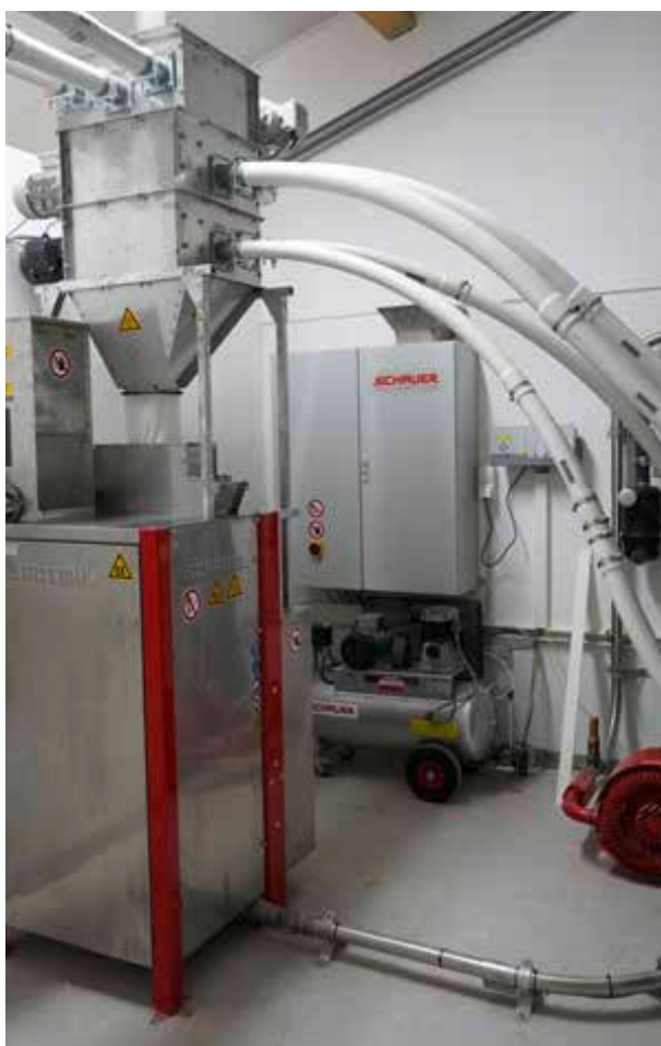
Bild 96: Hybridfütterung – Transport als Trockenfutter, Verteilung als Flüssigfutter
