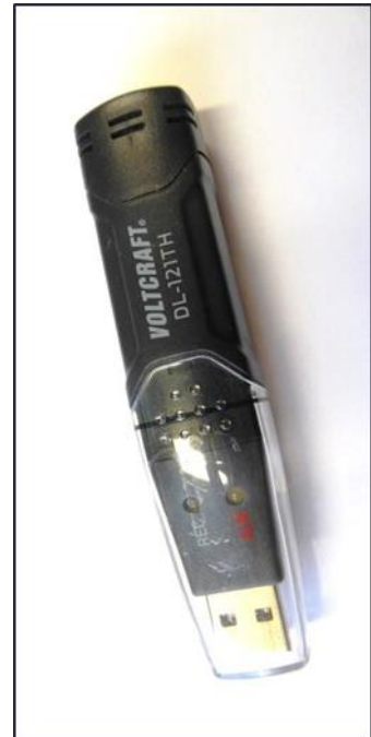
Abbildung 20: Datenlogger können kontinuierlich die Temperatur und Luftfeuchte erfassen. Die Daten können am PC ausgelesen werden
