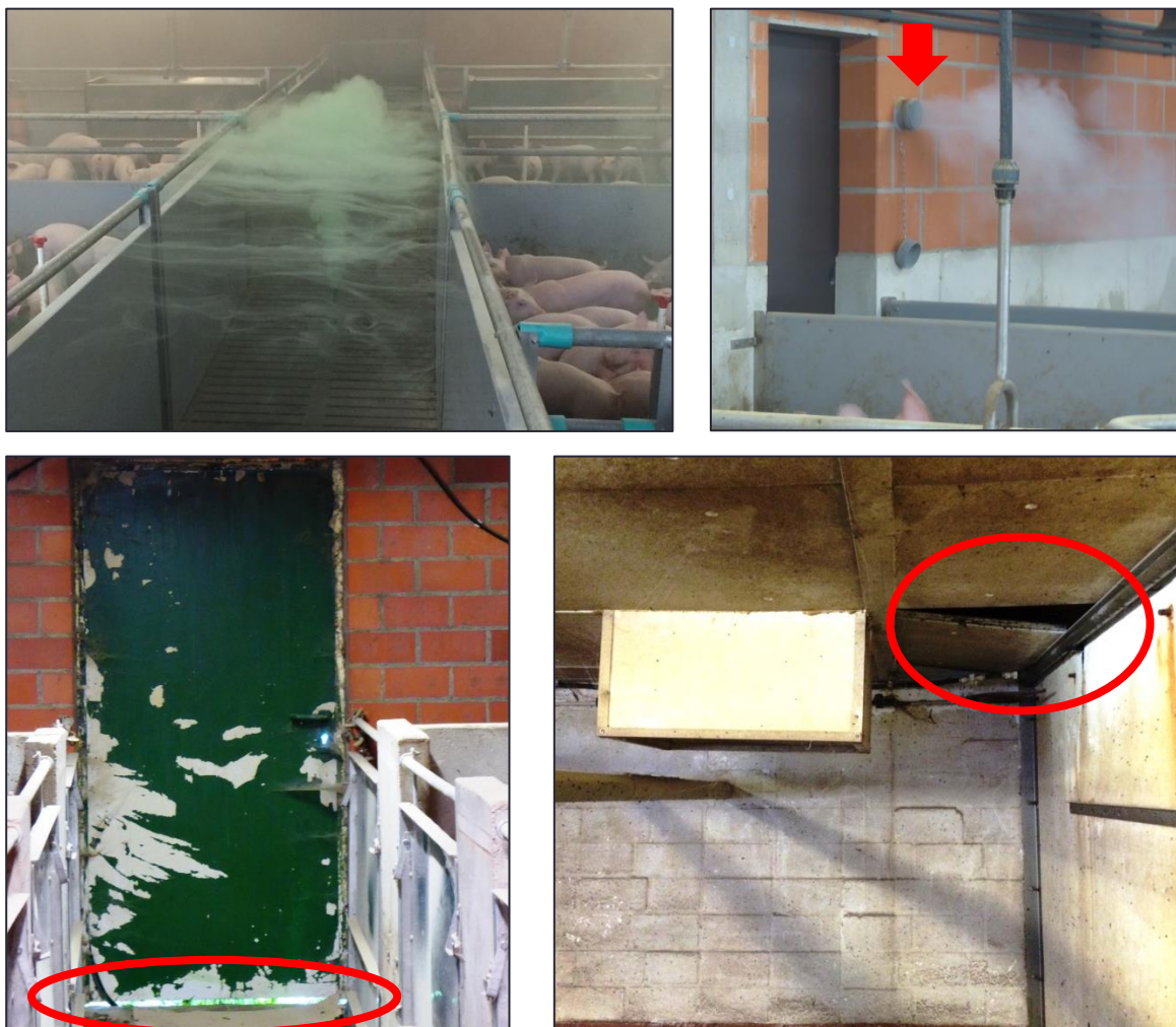
Abbildung 21: Mithilfe von Nebelpatronen lassen sich Luftströmungen im Abteil sehr gut sichtbar machen und überprüfen (oben links). Im oberen rechten Bild wird Falschlufteintrag sichtbar: Das Loch für die Versorgungskabel der Gaskanone vom Zentralgang wurde nicht abgedichtet. Durch den Türschlitz in der Fluchttür unten links dringt Falschluff direkt von außen in das Abteil. Zusätzlich haben Schadnager ungehinderten Zugang in das Abteil. Auch durch verrutschte Deckenplatten kann Falschluff direkt in das Abteil gelangen und Zugluft im Tierbereich verursachen (unten rechts).
