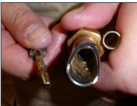
Abbildung 15: Mit Biofilm verschmutzter Tränkenippel.
