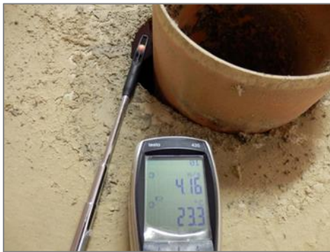
Bild 35: Undichtigkeiten im Abluftkanal
