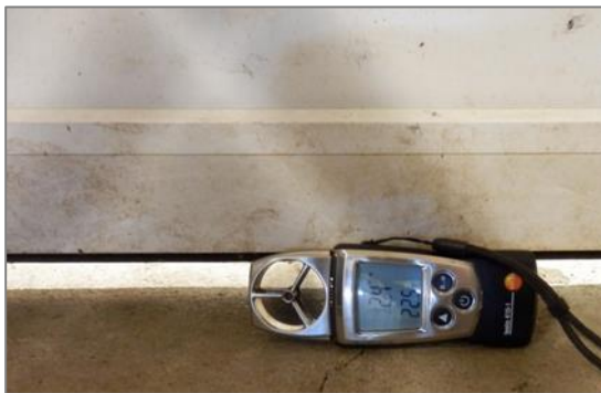
Bild 36: Undichtigkeiten an der Abteiltür
