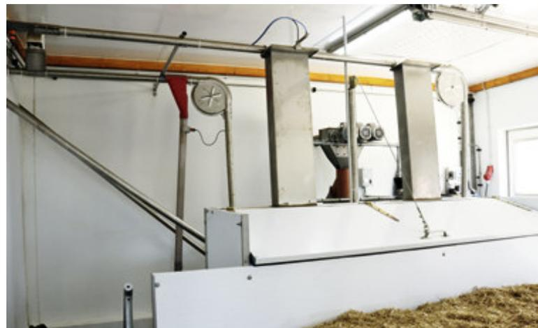
Systeme zum Einbringen von organischem Beschäftigungsmaterial in die Buchten werden von verschiedenen Firmen entwickelt, hier eine Lösung über eine Dosierstation.
